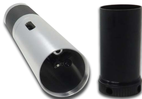
Измерительная камера снята с втулки зонда
